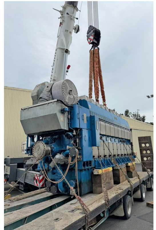
Blokkin úr Bergen Engines-skipavélinni eftir að búið var að strípa hana. Ljósmynd: Sigurður Sævar Sigurðsson/Héðinn
